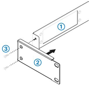
Der Rack Mount 2100-Bausatz besteht aus jeweils 2 Halteplatten ① und ② für jede Geräteseite, die zuerst mit je 2 der beiliegenden Schrauben ③ zu 2 Montagewinkeln miteinander verbunden werden, bevor diese mit den weiteren Schrauben an Gerät und Rack befestigt werden.
